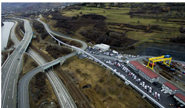
Le convoyeur sillonne une partie de l'A43 jusqu'au site de dépôt ▲ de Saint-Félix pour acheminer les déblais du tunnelier
